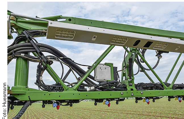
◁ Dank der zwischen den Kameras installierten LEDs kann man die One Smart Spray-Systeme auch nachts einsetzen.
