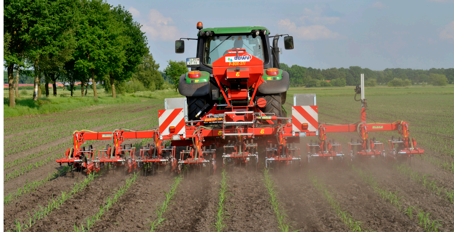
△ Die Kombination aus Kamera und Verschieberahmen erleichtert das Hacken enorm.
