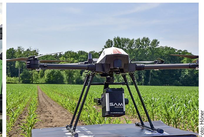
△ Im Offline-Verfahren erfolgt die Erkennung und Kartierung von Unkräutern in der Regel mittels Drohnen.
