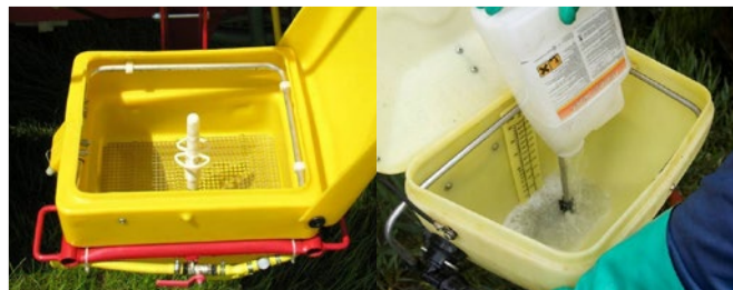
Einspülschleuse & Reinigung eines Behälters
