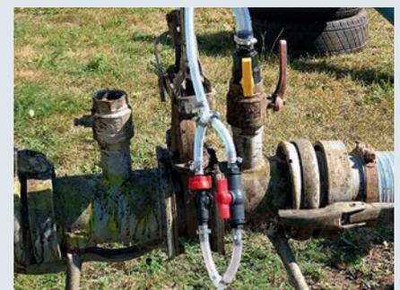
Zudosierung in den Ansaugschlauch
