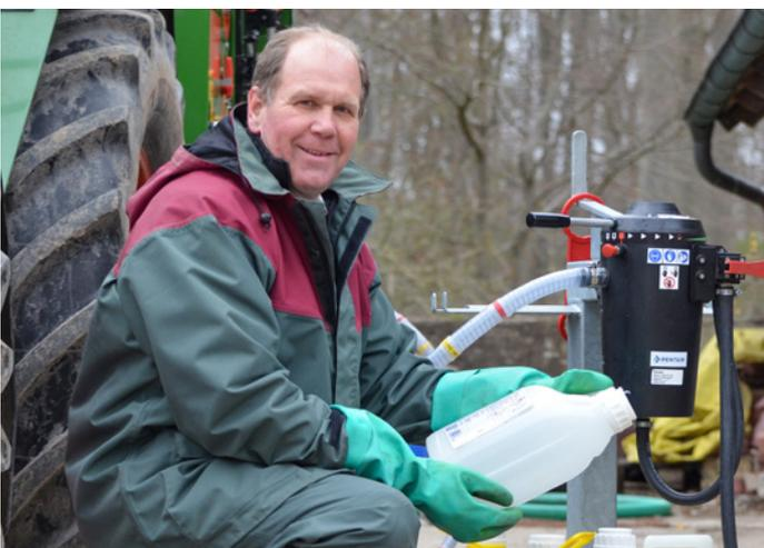
Ludger Helmer testet den Pentair-Coupler in der mobilen Variante auf dem rollbaren Rig und nutzt für das Frischwasser den Hausanschluss seines Spritzenbefüllplatzes.
