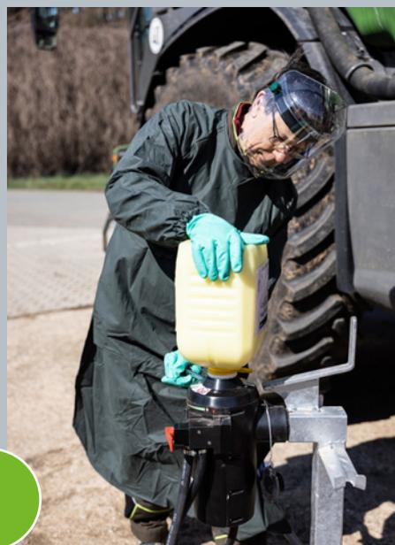
Der Behälter wird kopfüber auf den Coupler gesteckt und durch eine Drehbewegung des Haupthebels arretiert.
